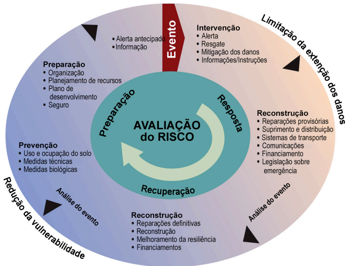
Figura 3.4 – O ciclo de gerenciamento de risco. Fonte: WWAP, 2006; adaptado de Swiss Civil Protection ; traduzido pelo autor.
